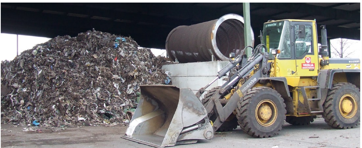
Abb. 3: Trommelsieb mit abgesiebten Störstoffen
